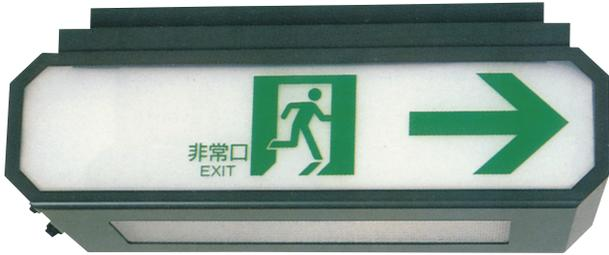
蓄電池一体型非常照明装置は、SOLAS 条約の改正に基づきロールオン・ロールオフ旅客船に対し新たに設置が義務づけられたものです。本装置は、蓄電池を一体として内蔵し、常に船内のAC100Vによって必要電力を充電しておき船内の主電源、非常電源及び臨時の非常電源の全てがその機能を停止したとき内蔵の蓄電池から自動的に給電し、いかなる傾斜状態にあっても、3時間以上、規定の照度以上の性能を維持し、災害発生による停電の際に心理的動揺を抑制し、避難路を明瞭にすることによって安全かつ円滑な避難行動を可能にする目的をもちています。
